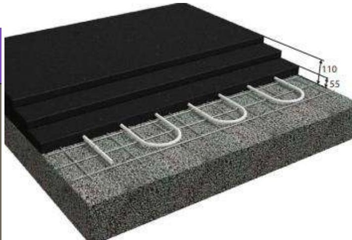
**!** На трубопровод может наноситься асфальтовое покрытие, температура которого не превышает 120°C, при условии, что по трубам будет циркулировать холодная вода под давлением 0,2 мПа.
