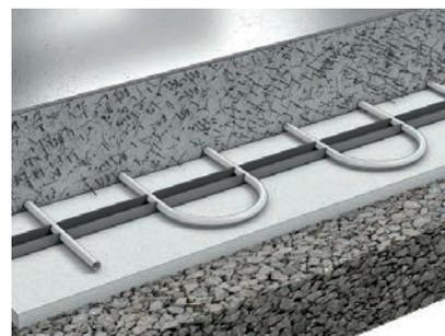
Напольное отопление и охлаждение USYSTEMS для промышленных объектов
