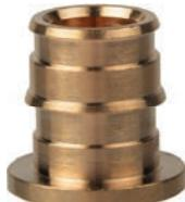
Фитинги из коррозионностойкой латуни для соединения труб из сшитого полиэтилена PE-Xa. Технология соединения трубы с фитингом основана на способности труб из сшитого полиэтилена восстанавливать свою первоначальную форму после расширения благодаря молекулярной памяти. Фитинги универсальны для труб серий S5,0 и S3,2 (PN6 и PN10). Кольца для монтажа следует заказывать отдельно.
