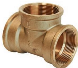
Изготовлен из стойкой к обесцинкованию латуни по DIN EN ISO 6509. Внутренняя трубная цилиндрическая резьба Rp по DIN EN 10226-1, ГОСТ 6211. Следует использовать уплотнительный материал по резьбе.
