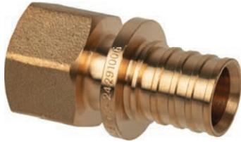
Фитинг из термообработанной латуни для соединения труб USYSTEMS PE-Xa S3,2 (PN10), Stabil Pipe с отопительными и санитарными приборами, резьбовыми коллекторами, запорно-регулирующей арматурой и т.п. Соединение с трубой выполняется путём опрессовки надвижной гильзы с помощью комплекта расширительного и напрессовочного инструментов. Внутренняя резьба трубная цилиндрическая Rp по DIN EN 10226-1, ГОСТ 6211.
