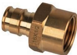
Фитинги из латуни для соединения труб из сшитого полиэтилена PE-Xa с отопительными и санитарными приборами, резьбовыми коллекторами, запорно-регулирующей арматурой и т.п. Технология соединения трубы с фитингом основана на способности труб из сшитого полиэтилена восстанавливать свою первоначальную форму после расширения благодаря молекулярной памяти. Внутренняя резьба – трубная цилиндрическая Rp по DIN EN 10226-1, ГОСТ 6211.
