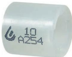
Изготавливается из сшитого полиэтилена PE-X. Кольца используются для монтажа соединений труб USYSTEMS PE-Xa с фитингами из латуни или PPSU, монтируемыми с помощью расширительного инструмента.
