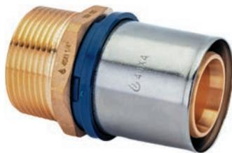
Изготавливается из латуни, с предустановленной пресс-гильзой из нержавеющей стали и защищающим от контакта с алюминиевым слоем трубы кольцом с контрольными отверстиями. Уплотнительные кольца из термостойкого EPDM. Пластмассовое упорное кольцо для позиционирования клещей инструмента профилей TH и U. Наружная резьба трубная коническая R по DIN EN 10226-1, ГОСТ 6211.
