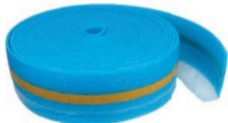
Демпферная лента из пористого полиэтилена для герметичного крепления к стене. Имеет клейкую тыльную сторону и продольный фартук из полиэтиленовой пленки. Укладывается по периметру помещения между стяжкой и смежными строительными конструкциями.
