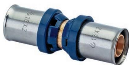
Изготавливается из латуни, с предустановленными пресс-гильзами из нержавеющей стали и защищающим от контакта с алюминиевым слоем трубы кольцом с контрольными отверстиями. Не требуется снятие фаски благодаря утопленным уплотнительным кольцам из термостойкого EPDM. Имеет функцию защиты от протечки. Пластмассовые упорные кольца для позиционирования клещей инструмента профилей ТН и U (26 мм – только ТН).
