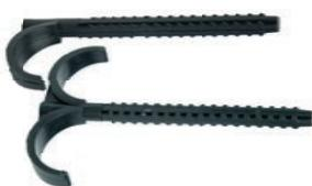
Изготавливается из устойчивого к ударным нагрузкам пластика, цвет чёрный. Для крепления труб с максимальным наружным диаметром 32 мм на бетонном основании. Монтажное отверстие 8 мм. Длина 100 мм.
