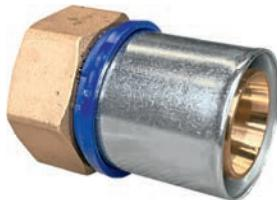
Изготавливается из латуни, с предустановленной пресс-гильзой из нержавеющей стали и защищающим от контакта с алюминиевым слоем трубы кольцом с контрольными отверстиями. Уплотнительные кольца из термостойкого EPDM. Имеет функцию защиты от протечки. Пластмассовое упорное кольцо для позиционирования клещей инструмента профиля TH. Подходит для подключения к кранам, фильтрам и вентилям с плоским уплотнением. Внутренняя резьба трубная цилиндрическая G по DIN EN ISO 228-1, ГОСТ 6357.
