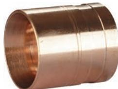
Гильза из термообработанной латуни, используется для монтажа соединений труб Stabil Pipe и труб PE-Xa S3,2 (PN10) с аксиальными фитингами USYSTEMS с помощью комплекта инструментов посредством надвижной опрессовки на фитинг после расширения трубы. Монтаж необходимо выполнять направлением внутренней фаски гильзы в сторону соединения.
