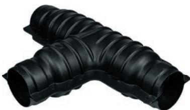
Комплекты для тепло- и гидроизоляции тройниковых соединений труб Thermo, Aqua, Varia – в исполнении Single и Twin, а также Supra Plus с кожухами 140, 175 и 200 мм. Комплект содержит изоляционный кожух, болты из нержавеющей стали, редукционные кольца, герметик. Фитинги для несущих труб в комплект не входят. Для труб Supra Plus следует дополнительно использовать комплект для кабеля (арт. 1136671). Использовать только совместно с термоусаживаемыми концевыми уплотнителями Usystems.
