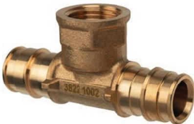
Фитинги из латуни для соединения труб из сшитого полиэтилена PE-Xa с отопительными и санитарными приборами, резьбовыми коллекторами, запорно-регулирующей арматурой и т.п. Технология соединения трубы с фитингом основана на способности труб из сшитого полиэтилена восстанавливать свою первоначальную форму после расширения благодаря молекулярной памяти. Внутренняя резьба – трубная цилиндрическая Rp по DIN EN 10226-1, ГОСТ 6211.
