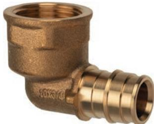
Фитинги из латуни для соединения труб из сшитого полиэтилена PE-Xa с отопительными и санитарными приборами, резьбовыми коллекторами, запорно-регулирующей арматурой и т.п. Технология соединения трубы с фитингом основана на способности труб из сшитого полиэтилена восстанавливать свою первоначальную форму после расширения благодаря молекулярной памяти. Внутренняя резьба – трубная цилиндрическая Rp по DIN EN 10226-1, ГОСТ 6211.
