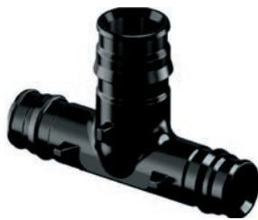
Полимерные фитинги из полифенилсульфона PPSU для соединения труб из свитого полиэтилена PE-Xa. Технология соединения трубы с фитингом основана на способности труб из свитого полиэтилена восстанавливать свою первоначальную форму после расширения благодаря молекулярной памяти. Фитинги универсальны для труб серий S5,0 и S3,2 (PN6 и PN10). Кольца для монтажа следует заказывать отдельно.
