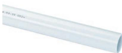
Кислородонепроницаемая металлополимерная композиционная труба (Полиэтилен повышенной термостойкости PERT II – Клей – Продольно сваренный встык алюминий – Клей – Полиэтилен повышенной термостойкости PE-RT II), для водоснабжения, радиаторного и напольного отопления, охлаждения.
