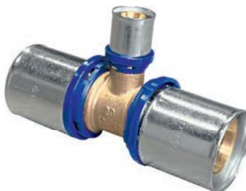
Изготавливается из латуни, с предустановленными пресс-гильзами из нержавеющей стали и защищающим от контакта с алюминиевым слоем трубы кольцом с контрольными отверстиями. Уплотнительные кольца из термостойкого EPDM. Имеет функцию защиты от протечки. Пластмассовые упорные кольца для позиционирования клещей инструмента профиля TH.
