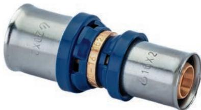
Изготавливается из латуни, с предустановленными пресс-гильзами из нержавеющей стали и защищающим от контакта с алюминиевым слоем трубы кольцом с контрольными отверстиями. Не требуется снятие фаски благодаря утопленным уплотнительным кольцам из термостойкого EPDM. Имеет функцию защиты от протечки. Пластмассовые упорные кольца для позиционирования клещей инструмента профилей ТН и U (26 мм – только ТН).
