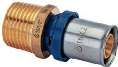
Изготавливается из латуни, с предустановленной пресс-гильзой из нержавеющей стали и защищающим от контакта с алюминиевым слоем трубы кольцом с контрольными отверстиями. Не требуется снятие фаски благодаря утопленным уплотнительным кольцам из термостойкого EPDM. Имеет функцию защиты от протечки. Пластмассовое упорное кольцо для позиционирования клещей инструмента профилей TH и U (26 мм – только TH). Наружная резьба трубная коническая R по DIN EN 10226-1, ГОСТ 6211.
