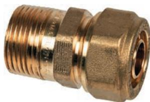
Зажимной фитинг стойкой к обесцинкованию латуни для соединения труб PE-Xa серии S3,2 (PN10). Фитинг Наружная резьба трубная коническая R по DIN EN 10226-1, ГОСТ 6211.
