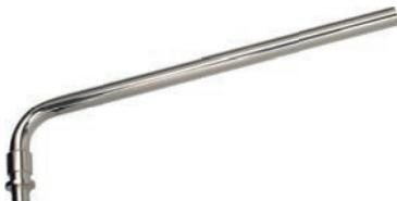
Для подключения труб USYSTEMS PE-Xa S3,2 (PN10), Stabil Pipe к отопительным приборам. Изготавливается из латунной трубы 15 x 1 мм длиной 300 мм. Подключение трубы 15 x 1 мм к радиаторному узлу 3/4"ВР Евроконус необходимо выполнять резьбовым адаптером 15CU. Соединение с трубой выполняется путём опрессовки надвижной гильзы с помощью комплекта расширитального и напрессовочного инструментов.
