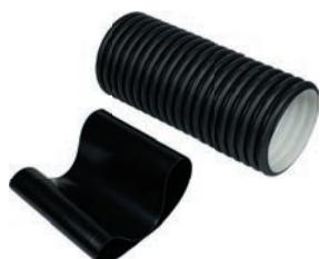
Для устройства прохода теплоизолированных труб через фундамент в местах, где отсутствует давление грунтовых вод. Набор состоит из проходной втулки длиной 550 мм, которая замуровывается в стене фундамента, термоусадочного рукава длиной 300 мм и ленты из термоактивируемого адгезива длиной 3 м.
