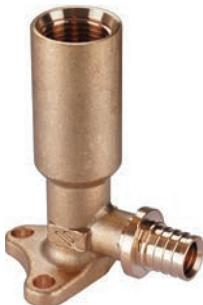
Фитинг из термообработанной латуни для подключения труб USYSTEMS PE-Xa S3,2 (PN10), Stabil Pipe к санитарным приборам. Соединение с трубой выполняется путём опрессовки надвижной гильзы с помощью комплекта расширительного и напрессовочного инструментов. Внутренняя резьба трубная цилиндрическая Rp по DIN EN 10226-1, ГОСТ 6211. Для непосредственного крепления к стене или монтажным планкам с расстоянием между отверстиями 40 мм.
