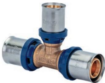
Изготавливается из латуни, с предустановленными пресс-гильзами из нержавеющей стали и защищающим от контакта с алюминиевым слоем трубы кольцом с контрольными отверстиями. Не требуется снятие фаски благодаря утопленным уплотнительным кольцам из термостойкого EPDM. Имеет функцию защиты от протечки. Пластмассовые упорные кольца для позиционирования клещей инструмента профилей TH и U (26 мм – только TH).
