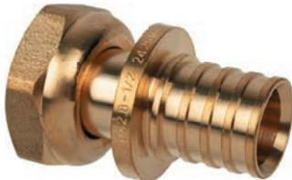
Фитинг из термообработанной латуни для соединения труб USYSTEMS PE-Xa S3,2 (PN10), Stabil Pipe с отопительными и санитарными приборами, резьбовыми коллекторами, запорно-регулирующей арматурой и т.п. Соединение с трубой выполняется путём опрессовки надвижной гильзы с помощью комплекта расширительного и напрессовочного инструментов. Внутренняя резьба трубная цилиндрическая G по DIN EN 228-1, ГОСТ 6357.
