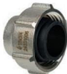
Для подключения медной/латунной трубы 15 x 1 мм тройников и уголков к радиаторным узлам 3/4"НР Евроконус. Внутренняя резьба 3/4"ВР Евроконус. Состав: покрытая латунная гайка, встроенное латунное зажимное кольцо и уплотнительный конус из EPDM. Оребренная гайка под гаечный ключ 30.
