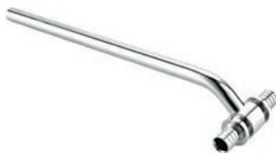
Для подключения труб USYSTEMS PE-Xa S3,2 (PN10), Stabil Pipe к отопительным приборам. Изготавливается из латунной трубы 15 x 1 мм длиной 300 мм. Подключение трубы 15 x 1 мм к радиаторному узлу 3/4"ВР Евроконус необходимо выполнять резьбовым адаптером 15СU. Соединение с трубой выполняется путём опрессовки надвижной гильзы с помощью комплекта расширительного и напрессовочного инструментов.
