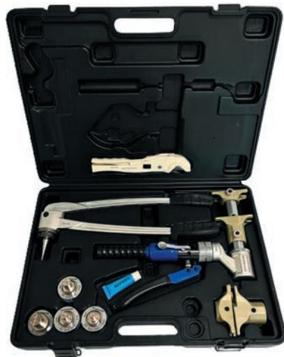
Инструмент для монтажа соединений труб из сшитого полиэтилена PE-Xa S3,2 (PN10) и Stabil с аксиальными фитингами USYSTEMS посредством надвижной опрессовки гильзы на фитинг после расширения трубы.
