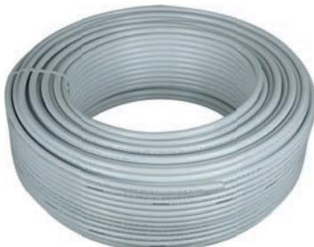
Кислородонепроницаемая металлополимерная композиционная труба (Полиэтилен повышенной термостойкости PERT II – Клей – Продольно сваренный встык алюминий – Клей – Полиэтилен повышенной термостойкости PE-RT II), для водоснабжения, радиаторного и напольного отопления, охлаждения.
