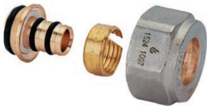
Зажимной адаптер, состоит из штуцера, обжимного кольца и гайки из латуни. Для подключения труб Usystems MLC к коллекторам и радиаторным узлам с наружной резьбой 3/4"НР Евроконус. Внутренняя резьба трубная цилиндрическая G по EN ISO 228-1, ГОСТ 6357. Перед монтажом необходимо снять фаску и откалибровать трубу.
