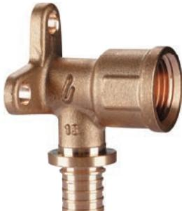
Фитинг из термообработанной латуни для подключения труб USYSTEMS PE-Xa S3,2 (PN10), Stabil Pipe к санитарным приборам. Соединение с трубой выполняется путём опрессовки надвижной гильзы с помощью комплекта расширительного и напрессовочного инструментов. Внутренняя резьба трубная цилиндрическая Rp по DIN EN 10226-1, ГОСТ 6211. Для непосредственного крепления к стене или монтажным планкам с расстоянием между отверстиями 40 мм.
