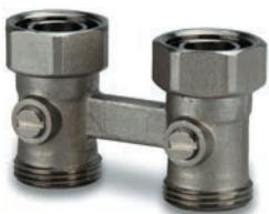
Узел для подключения к радиатору с нижней подводкой. Прямое исполнение, без байпаса. Имеет встроенные запорные краны.
