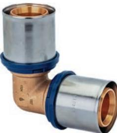
Изготавливается из латуни, с предустановленными пресс-гильзами из нержавеющей стали и защищающим от контакта с алюминиевым слоем трубы кольцом с контрольными отверстиями. Уплотнительные кольца из термостойкого EPDM. Пластмассовые упорные кольца для позиционирования клещей инструмента профилей ТН и U.
