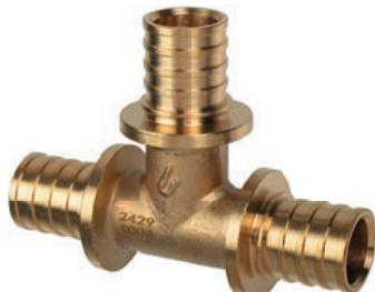
Фитинг из термообработанной латуни для соединения труб USYSTEMS PE-Xa S3,2 (PN10), Stabil Pipe путём опрессовки надвижной гильзы. Монтаж с помощью комплекта расширительного и напрессовочного инструментов.
