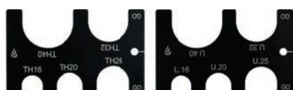
Инструмент для контроля профиля опрессованного инструментом фитинга Usystems MLC (Plus) 16-40 мм.
