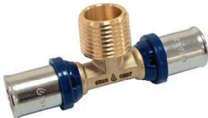
Изготавливается из латуни, с предустановленными пресс-гильзами из нержавеющей стали и защищающим от контакта с алюминиевым слоем трубы кольцом с контрольными отверстиями. Не требуется снятие фаски благодаря утопленным уплотнительным кольцам из термостойкого EPDM. Имеет функцию защиты от протечки. Пластмассовое упорное кольцо для позиционирования клещей инструмента профилей TH и U (26 мм – только TH). Наружная резьба трубная коническая R по DIN EN 10226-1, ГОСТ 6211.
