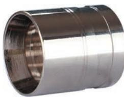
Гильза из термообработанной латуни с покрытием серебристого цвета, используется для монтажа соединений труб Stabil Pipe и труб PE-Xa S3,2 (PN10) с аксиальными фитингами USYSTEMS с помощью комплекта инструментов посредством надвижной опрессовки на фитинг после расширения трубы. Монтаж необходимо выполнять направлением внутренней фаски гильзы в сторону соединения.
