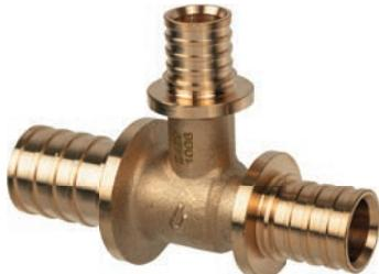
Фитинг из термообработанной латуни для соединения труб USYSTEMS PE-Xa S3,2 (PN10), Stabil Pipe путём опрессовки надвижной гильзы. Монтаж с помощью комплекта расширительного и напрессовочного инструментов.
