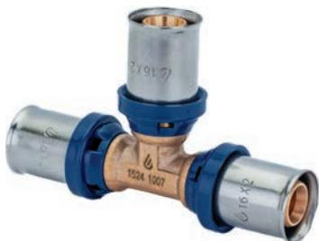
Изготавливается из латуни, с предустановленными пресс-гильзами из нержавеющей стали и защищающим от контакта с алюминиевым слоем трубы кольцом с контрольными отверстиями. Не требуется снятие фаски благодаря утопленным уплотнительным кольцам из термостойкого EPDM. Имеет функцию защиты от протечки. Пластмассовые упорные кольца для позиционирования клещей инструмента профилей ТН и У (26 мм – только ТН).
