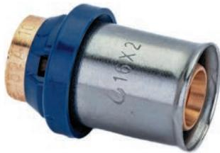
Изготавливается из латуни, с предустановленной пресс-гильзой из нержавеющей стали и защищающим от контакта с алюминиевым слоем трубы кольцом с контрольными отверстиями. Не требуется снятие фаски благодаря утопленным уплотнительным кольцам из термостойкого EPDM. Имеет функцию защиты от протечки. Пластмассовое упорное кольцо для позиционирования клещей инструмента профилей ТН и У.
