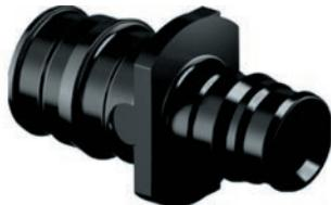
Полимерные фитинги из полифенилсульфона PPSU для соединения труб из свитого полиэтилена PE-Xa. Технология соединения трубы с фитингом основана на способности труб из свитого полиэтилена восстанавливать свою первоначальную форму после расширения благодаря молекулярной памяти. Фитинги универсальны для труб серий S5,0 и S3,2 (PN6 и PN10). Кольца для монтажа следует заказывать отдельно.
