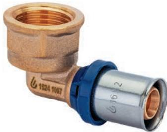
Изготавливается из латуни, с предустановленной пресс-гильзой из нержавеющей стали и защищающим от контакта с алюминиевым слоем трубы кольцом с контрольными отверстиями. Не требуется снятие фаски благодаря утопленным уплотнительным кольцам из термостойкого EPDM. Имеет функцию защиты от протечки. Пластмассовое упорное кольцо для позиционирования клещей инструмента профилей TH и U (26 мм – только TH). Внутренняя резьба трубная цилиндрическая Rp по DIN EN 10226-1, ГОСТ 6211.
