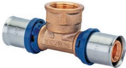
Изготавливается из латуни, с предустановленными пресс-гильзами из нержавеющей стали и защищающим от контакта с алюминиевым слоем трубы кольцом с контрольными отверстиями. Не требуется снятие фаски благодаря утопленным уплотнительным кольцам из термостойкого EPDM. Имеет функцию защиты от протечки. Пластмассовые упорные кольца для позиционирования клещей инструмента профилей TH и U (26 мм – только TH).
