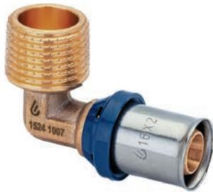
Изготавливается из латуни, с предустановленной пресс-гильзой из нержавеющей стали и защищающим от контакта с алюминиевым слоем трубы кольцом с контрольными отверстиями. Не требуется снятие фаски благодаря утопленным уплотнительным кольцам из термостойкого EPDM. Имеет функцию защиты от протечки. Пластмассовое упорное кольцо для позиционирования клещей инструмента профилей TH и U. Наружная резьба трубная коническая R по DIN EN 10226-1, ГОСТ 6211.
