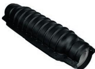
Комплекты для тепло- и гидроизоляции прямых соединений труб Thermo, Aqua, Varia – в исполнении Single и Twin, а также Supra Plus с кожухами 140, 175 и 200 мм. Комплект содержит изоляционный кожух, болты из нержавеющей стали, редукционные кольца, герметик. Фитинги для несущих труб в комплект не входят. Для труб Supra Plus следует дополнительно использовать комплект для кабеля (арт. 1136671). Использовать только совместно с термоусаживаемыми концевыми уплотнителями Usystems.
