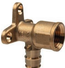
Фитинги из латуни для подключения труб из сшитого полиэтилена PE-Xa к санитарным приборам. Технология соединения трубы с фитингом основана на способности труб из сшитого полиэтилена восстанавливать свою первоначальную форму после расширения благодаря молекулярной памяти. Внутренняя резьба – трубная цилиндрическая Rp по DIN EN 10226-1, ГОСТ 6211.
