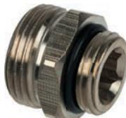
Изготавливается из покрытой латуни, с самоуплотнением. Предназначен для радиаторных узлов с внутренней резьбой 1/2"ВР, служит переходом с внутренней резьбы 1/2"ВР на наружную резьбу 3/4"НР Евроконус, совместим с резьбовыми адаптерами.
