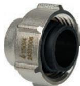
Для подключения медной/латунной трубы 15 x 1 мм тройников и уголков к радиаторным узлам 3/4"НР Евроконус. Внутренняя резьба 3/4"ВР Евроконус. Состав: покрытая латунная гайка, встроенное латунное зажимное кольцо и уплотнительный конус из EPDM. Оребренная гайка под гаечный ключ 30.
