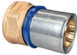
Изготавливается из латуни, с предустановленной пресс-гильзой из нержавеющей стали и защищающим от контакта с алюминиевым слоем трубы кольцом с контрольными отверстиями. Уплотнительные кольца из термостойкого EPDM. Имеет функцию защиты от протечки. Пластмассовое упорное кольцо для позиционирования клещей инструмента профиля TH. Внутренняя резьба трубная цилиндрическая Rp по DIN EN 10226-1, ГОСТ 6211.
