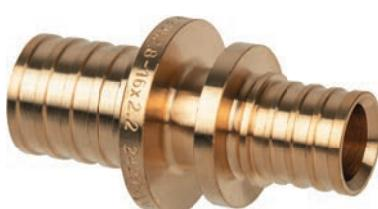
Фитинг из термообработанной латуни для соединения труб USYSTEMS PE-Xa S3,2 (PN10), Stabil Pipe путём опрессовки надвижной гильзы. Монтаж с помощью комплекта расширительного и напрессовочного инструментов.
