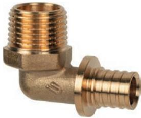
Фитинг из термообработанной латуни для соединения труб USYSTEMS PE-Xa S3,2 (PN10), Stabil Pipe с отопительными и санитарными приборами, резьбовыми коллекторами, запорно-регулирующей арматурой и т.п. Соединение с трубой выполняется путём опрессовки надвижной гильзы с помощью комплекта расширительного и напрессовочного инструментов. Наружная резьба трубная коническая R по DIN EN 10226-1, ГОСТ 6211.
