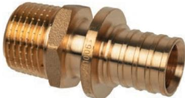
Фитинг из термообработанной латуни для соединения труб USYSTEMS PE-Xa S3,2 (PN10), Stabil Pipe с отопительными и санитарными приборами, резьбовыми коллекторами, запорно-регулирующей арматурой и т.п. Соединение с трубой выполняется путём опрессовки надвижной гильзы с помощью комплекта расширительного и напрессовочного инструментов. Наружная резьба трубная коническая R по DIN EN 10226-1, ГОСТ 6211.
