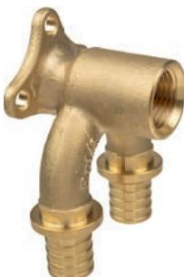
Фитинг из термообработанной латуни для подключения труб USYSTEMS PE-Xa S3,2 (PN10), Stabil Pipe к санитарным приборам. Соединение с трубой выполняется путём опрессовки надвижной гильзы с помощью комплекта расширительного и напрессовочного инструментов. Проходная водорозетка для кольцевой разводки. Внутренняя резьба трубная цилиндрическая Rp по DIN EN 10226-1, ГОСТ 6211. Для непосредственного крепления к стене или монтажным планкам с расстоянием между отверстиями 40 мм.
