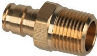
Фитинги из латуни для соединения труб из сшитого полиэтилена PE-Xa с отопительными и санитарными приборами, резьбовыми коллекторами, запорно-регулирующей арматурой и т.п. Технология соединения трубы с фитингом основана на способности труб из сшитого полиэтилена восстанавливать свою первоначальную форму после расширения благодаря молекулярной памяти.
