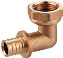
Фитинг из термообработанной латуни для соединения труб USYSTEMS PE-Xa S3,2 (PN10), Stabil Pipe с отопительными и санитарными приборами, резьбовыми коллекторами, запорно-регулирующей арматурой и т.п. Соединение с трубой выполняется путём опрессовки надвижной гильзы с помощью комплекта расширительного и напрессовочного инструментов. Внутренняя резьба трубная цилиндрическая G по DIN EN ISO 228-1, ГОСТ 6357.
