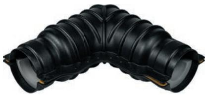
Комплекты для тепло- и гидроизоляции угловых соединений труб Thermo, Aqua, Varia – в исполнении Single и Twin, а также Supra Plus с кожухами 140, 175 и 200 мм. Комплект содержит изоляционный кожух, болты из нержавеющей стали, редукционные кольца, герметик. Фитинги для несущих труб в комплект не входят. Для труб Supra Plus следует дополнительно использовать комплект для кабеля (арт. 1136671). Использовать только совместно с термоусаживаемыми концевыми уплотнителями Usystems.
