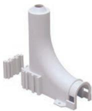
Изготавливается из пластика. Для фиксации загиба труб PE-Xa диаметром 16 мм при подключении к радиатору. Разборный, для кожуха 25/20 мм. Минимальное межосевое расстояние между трубами при использовании двух фиксаторов – 50. В комплект входит один фиксатор.
