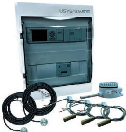
Комплект автоматического управления системой поверхностного гидравлического снеготаяния для предотвращения образования сугробов и наледей. Принцип работы: по показаниям датчиков температуры и осадков контроллер управляет двух- или трёхходовым клапаном, а также включает/останавливает циркуляционный насос и теплогенератор (опционально), запуская или прерывая циркуляцию теплоносителя в контуре труб системы снеготаяния, тем самым контролируя температуру обогреваемой поверхности.
