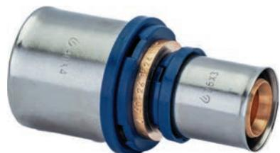
Изготавливается из латуни, с предустановленными пресс-гильзами из нержавеющей стали и защищающим от контакта с алюминиевым слоем трубы кольцом с контрольными отверстиями. Уплотнительные кольца из термостойкого EPDM. Пластмассовые упорные кольца для позиционирования клещей инструмента профилей ТН и U (26 мм – только ТН).
