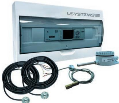
Комплект автоматического управления системой поверхностного гидравлического снеготаяния для предотвращения образования сугробов и наледей. Принцип работы: по показаниям датчиков температуры и осадков контроллер управляет двух- или трёхходовым клапаном, а также включает/останавливает циркуляционный насос и теплогенератор (опционально), запуская или прерывая циркуляцию теплоносителя в контуре труб системы снеготаяния, тем самым контролируя температуру обогреваемой поверхности.
