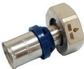
Изготавливается из латуни, с предустановленной пресс-гильзой из нержавеющей стали и защищающим от контакта с алюминиевым слоем трубы кольцом с контрольными отверстиями. Не требуется снятие фаски благодаря утопленным уплотнительным кольцам из термостойкого EPDM. Имеет функцию защиты от протечки. Пластмассовое упорное кольцо для позиционирования клещей инструмента профилей ТН и У. Внутренняя резьба трубная цилиндрическая G3/4" Евроконус по DIN EN ISO 228-1, ГОСТ 6357.
