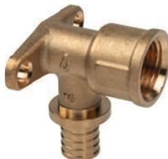
Фитинг из термообработанной латуни для подключения труб USYSTEMS PE-Xa S3,2 (PN10), Stabil Pipe к санитарным приборам. Соединение с трубой выполняется путём опрессовки надвижной гильзы с помощью комплекта расширительного и напрессовочного инструментов. Внутренняя резьба трубная цилиндрическая Rp по DIN EN 10226-1, ГОСТ 6211.
