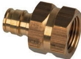
Фитинги из латуни для соединения труб из сшитого полиэтилена PE-Xa с отопительными и санитарными приборами, резьбовыми коллекторами, запорно-регулирующей арматурой и т.п. Технология соединения трубы с фитингом основана на способности труб из сшитого полиэтилена восстанавливать свою первоначальную форму после расширения благодаря молекулярной памяти. Внутренняя резьба – трубная цилиндрическая G по DIN EN ISO 228-1, ГОСТ 6357.
