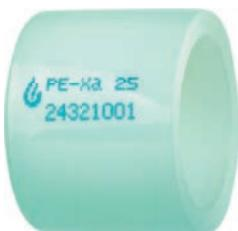
Изготавливается из свитого полиэтилена PE-X. Кольца используются для монтажа соединений труб USYSTEMS PE-Xa с фитингами из латуни или PPSU, монтируемыми с помощью расширительного инструмента.
