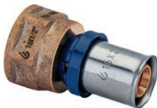
Изготавливается из латуни, с предустановленной пресс-гильзой из нержавеющей стали и защищающим от контакта с алюминиевым слоем трубы кольцом с контрольными отверстиями. Не требуется снятие фаски благодаря утопленным уплотнительным кольцам из термостойкого EPDM. Имеет функцию защиты от протечки. Пластмассовое упорное кольцо для позиционирования клещей инструмента профилей TH и U (26 мм – только TH). Внутренняя резьба трубная цилиндрическая Rp по DIN EN 10226-1, ГОСТ 6211.
