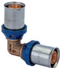
Изготавливается из латуни, с предустановленными пресс-гильзами из нержавеющей стали и защищающим от контакта с алюминиевым слоем трубы кольцом с контрольными отверстиями. Не требуется снятие фаски благодаря утопленным уплотнительным кольцам из термостойкого EPDM. Имеет функцию защиты от протечки. Пластмассовые упорные кольца для позиционирования клещей инструмента профилей ТН и U (26 мм – только ТН).
