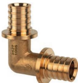
Фитинг из термообработанной латуни для соединения труб USYSTEMS PE-Xa S3,2 (PN10), Stabil Pipe путём опрессовки надвижной гильзы. Монтаж с помощью комплекта расширительного и напрессовочного инструментов.
