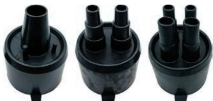
Предназначен для гидроизоляции торца теплоизоляции на концах теплоизолированных труб. В комплект входят резиновый концевой уплотнитель, хомут из нержавеющей стали и уплотнительное кольцо. Для теплоизолированных труб с одной, двумя и четырьмя несущими трубами.
