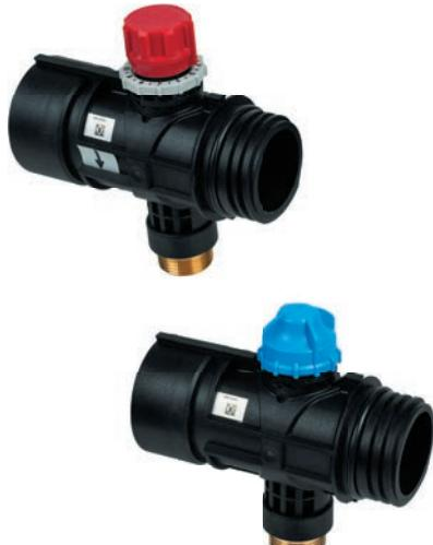
Промышленный коллектор диаметром 1 1/2" для напольного отопления больших площадей, а также систем снеготаяния. В комплект входят: подающий сегмент с балансировочным вентилем, имеющий одиночный выход 3/4"НР Евроконус;
