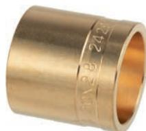
Гильза из термообработанной латуни, используется для монтажа соединений труб из сшитого полиэтилена PE-Xa S3,2 (PN10) с аксиальными фитингами USYSTEMS с помощью комплекта инструментов посредством надвижной опрессовки на фитинг после расширения трубы. Монтаж необходимо выполнять направлением внутренней фаски гильзы в сторону соединения.
