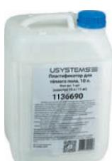
Пластификатор для улучшения тепло-физических свойств стяжки тёплого пола. Расход 7,7 л на 100 кг цемента. Допускается однократное замораживание при транспортировании.
