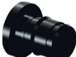
Полимерные фитинги из полифенилсульфона PPSU для соединения труб из свитого полиэтилена PE-Xa. Технология соединения трубы с фитингом основана на способности труб из свитого полиэтилена восстанавливать свою первоначальную форму после расширения благодаря молекулярной памяти. Фитинги универсальны для труб серий S5,0 и S3,2 (PN6 и PN10). Кольца для монтажа следует заказывать отдельно.
