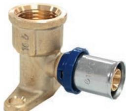
Изготавливается из латуни, с предустановленной пресс-гильзой из нержавеющей стали и защищающим от контакта с алюминиевым слоем трубы кольцом с контрольными отверстиями. Не требуется снятие фаски благодаря утопленным уплотнительным кольцам из термостойкого EPDM. Имеет функцию защиты от протечки. Пластмассовое упорное кольцо для позиционирования клещей инструмента профилей TH и U. Внутренняя резьба трубная цилиндрическая Rp по DIN EN 10226-1, ГОСТ 6211.
