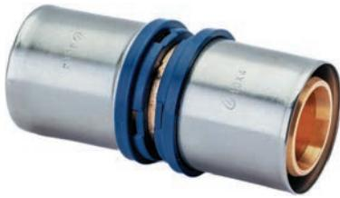
Изготавливается из латуни, с предустановленными пресс-гильзами из нержавеющей стали и защищающим от контакта с алюминиевым слоем трубы кольцом с контрольными отверстиями. Уплотнительные кольца из термостойкого EPDM. Пластмассовые упорные кольца для позиционирования клещей инструмента профилей ТН и U.
