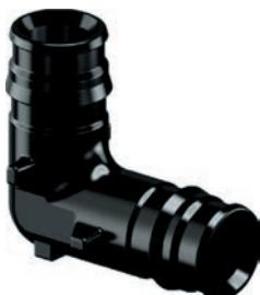
Полимерные фитинги из полифенилсульфона PPSU для соединения труб из свитого полиэтилена PE-Xa. Технология соединения трубы с фитингом основана на способности труб из свитого полиэтилена восстанавливать свою первоначальную форму после расширения благодаря молекулярной памяти. Фитинги универсальны для труб серий S5,0 и S3,2 (PN6 и PN10). Кольца для монтажа следует заказывать отдельно.
