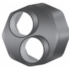
Предназначен для гидроизоляции торца теплоизоляции на концах теплоизолированных труб. В комплект входят концевой уплотнитель и уплотнительная лента-герметик. Герметичность достигается за счёт термоусадки с помощью нагрева. Для теплоизолированных труб с одной, двумя и четырьмя несущими трубами.
