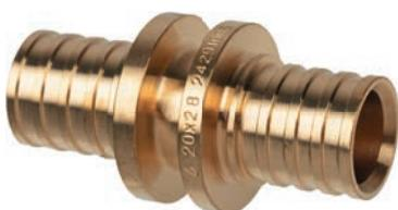
Фитинг из термообработанной латуни для соединения труб USYSTEMS PE-Xa S3,2 (PN10), Stabil Pipe путём опрессовки надвижной гильзы. Монтаж с помощью комплекта расширительного и напрессовочного инструментов.
