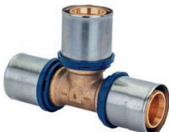
Изготавливается из латуни, с предустановленными пресс-гильзами из нержавеющей стали и защищающим от контакта с алюминиевым слоем трубы кольцом с контрольными отверстиями. Уплотнительные кольца из термостойкого EPDM. Пластмассовые упорные кольца для позиционирования клещей инструмента профилей ТН и У.
