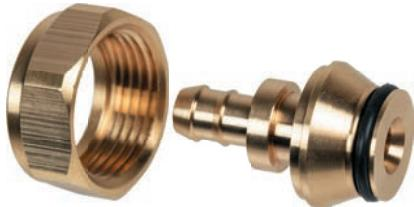
Фитинг из латуни для подключения труб из сшитого полиэтилена PE-Xa 10/9,9 мм к коллекторам с наружной резьбой 3/4" Евроконус. Технология соединения трубы с фитингом основана на способности труб из сшитого полиэтилена восстанавливать свою первоначальную форму после расширения благодаря молекулярной памяти. Внутренняя резьба – трубная цилиндрическая G3/4" Евроконус по DIN EN ISO 228-1, ГОСТ 6357.
