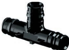
Полимерные фитинги из полифенилсульфона PPSU для соединения труб из сшитого полиэтилена PE-Xa. Технология соединения трубы с фитингом основана на способности труб из сшитого полиэтилена восстанавливать свою первоначальную форму после расширения благодаря молекулярной памяти. Фитинги универсальны для труб серий S5,0 и S3,2 (PN6 и PN10). Кольца для монтажа следует заказывать отдельно.
