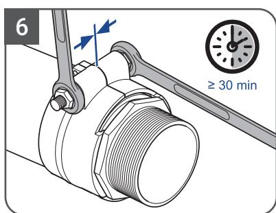
Затяните болт до тех пор, пока прижимные
