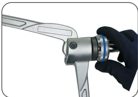
Установите расширительную головку соответствующего диаметра на расширитель до упора.
