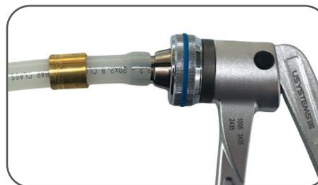
Вставьте фитинг в трубу таким образом, чтобы конец не доходил 1-3 мм до стопорного бортика. Установите трубу с фитингом на напрессовочные тиски
