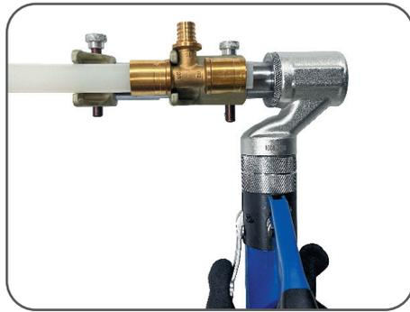
Нажмите на спусковой клапан для возврата поршня в исходное положение, снимите готовое соединение.
