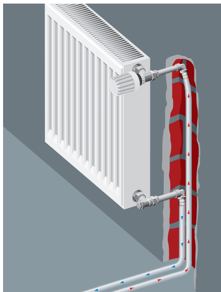
б) Подключение радиатора «бокoвое, от стены» с помощью никелированных латунных пресс-угольников. Присоединение латунных пресс-угольников к радиаторному узлу осуществляется резьбовыми адаптерами для латунных трубок.
