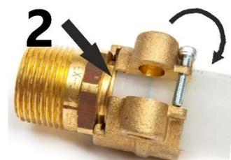
3. Смажьте резьбу болта и гайки и установите болт на прежнее место. Резьба болта предварительно смазывается на заводе, но в случае длительного хранения, особенно при повышенной влажности и при затягивании соединений больших диаметров (63мм и более), возможно, потребуется дополнительная смазка, во избежание повреждения резьбы.
