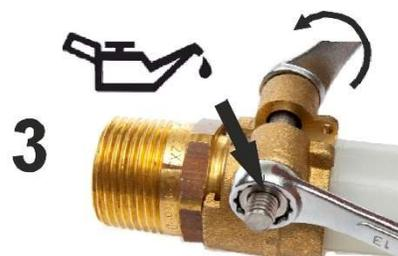
4. Затяните болт до тех пор, пока две половинки зажимной гильзы не сомкнутся. В зависимости от обстоятельств (например, холодная погода, когда труба становится жёстче) и/или соединения больших диаметров, затяжку лучше производить в несколько этапов и делать между ними небольшие перерывы (от 30 мин). Это позволяет снизить напряжение в трубе и гильзе и закрутить соединение до конца.
